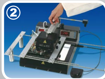
2 Calefactor superior en posicion baja para reflow
